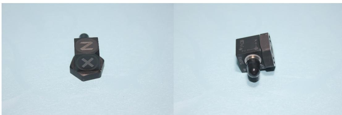
图 3-10 356A16 型三向加速度器
