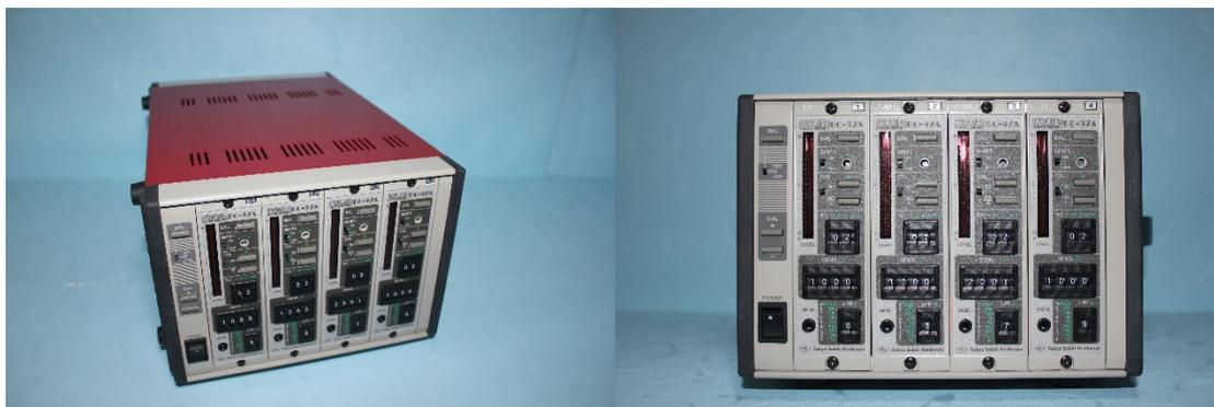
图 3-21 DC-97A 高速动态应变仪
