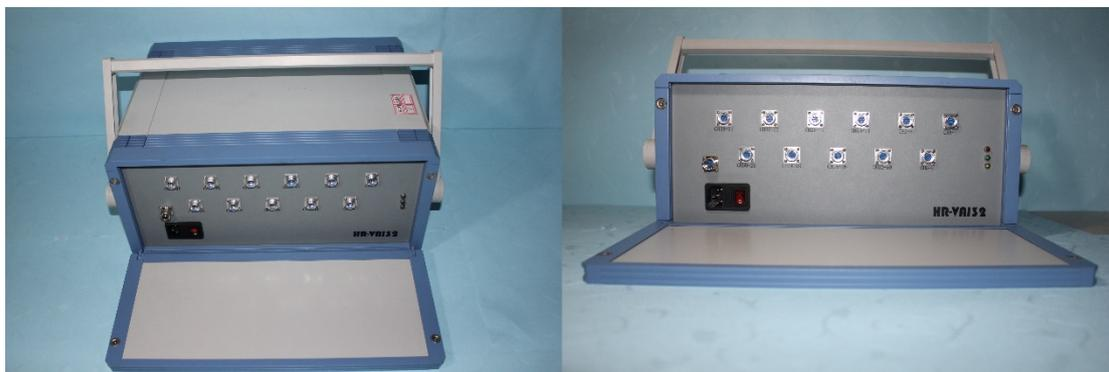
图 2-9 HR-VAI32 振动采集仪
