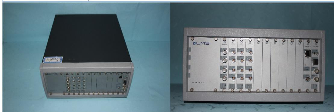
图 2-3 LMS SCADAS Mobile 便携式 36 通道数据采集仪
