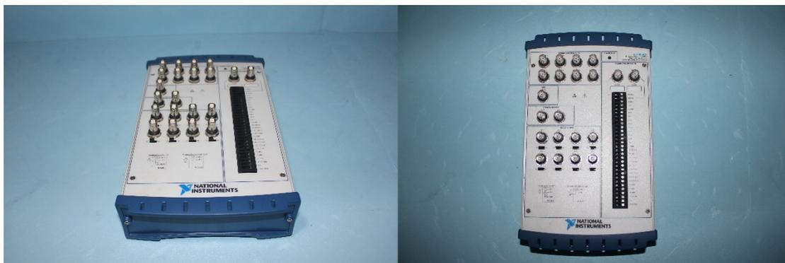
图 2-4 NI USB-6251 BNC 数据采集仪
