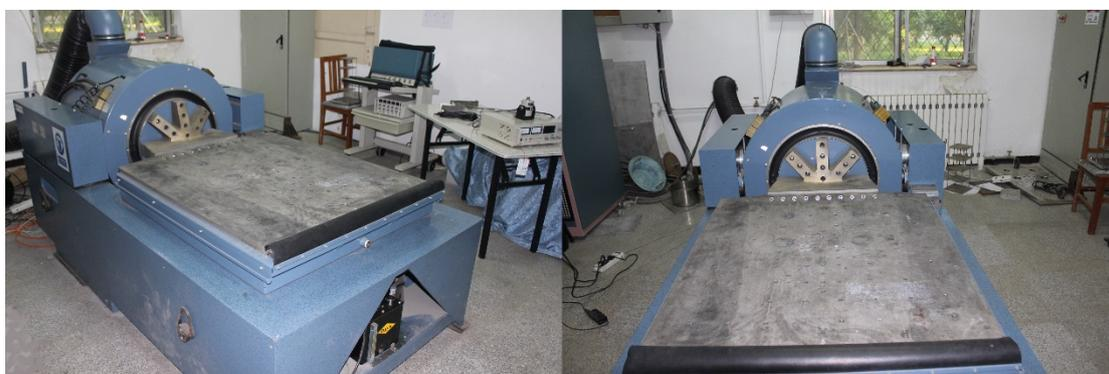
图 1-1 多用途电磁振动台
