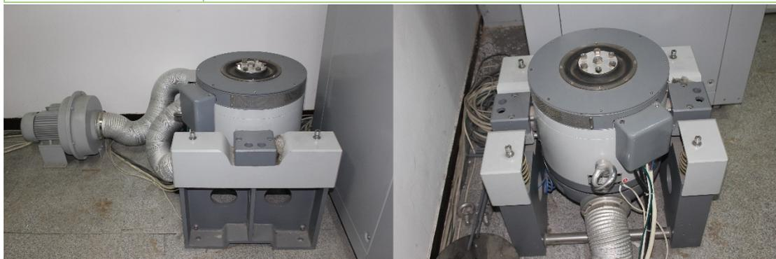
图 1-5 D-100-2 电动振动试验系统
