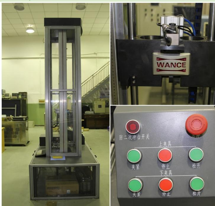
图 1-3 DIT-123E 落锤冲击试验机
