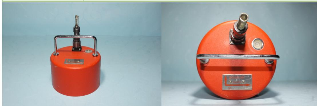
图 3-19 CDJ-S2C-2 型三分量检波器
