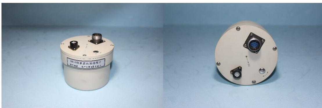
图 3-14 HR10 型垂直向加速度器
