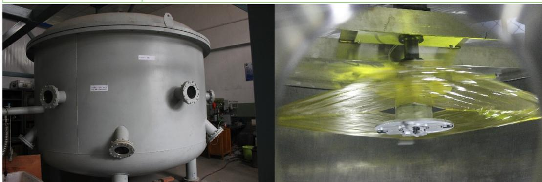
图 1-2 真空舱及太阳帆展开实验
